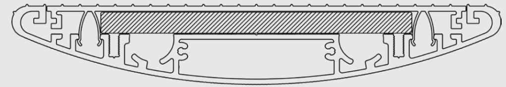
Marches — Elles sont silencieuses sous les pieds, antidérapants et l'anodisation crée une surface supérieure dure et durable. Les marches peuvent mesurer jusqu'à 1200 mm de large et la grande profondeur de marche (280 mm) offre un confort de marche optimal.
